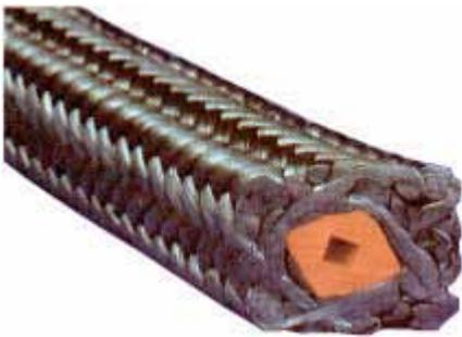
Fabricada com fibra de PTFE Expandido lubrificado, com núcleo de PLC. Esta combinação mantém a gaxeta constantemente em contato com o eixo e a caixa. Projetada especificamente para equipamentos com excentricidade no eixo. Este estilo tem apresentado uma excelente performance em filtros lavadores, agitadores, depuradores, cristalizadores etc... Chegando até compensar e/ou corrigir defeitos dos equipamentos; é a única gaxeta com memória.
