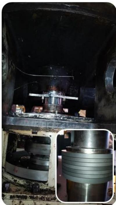
O conjunto de vedação THERMOCARBON-8000-TGC combina materiais exclusivos para vedar a caixa de gaxetas, em sistema de refino de madeira sem a necessidade de injeção de graxa ou água. O processo construtivo agregam ao produto excelente desempenho, indicado como a melhor opção do mercado industrial para vedação em digestores e rosca extratoras, mesmo nas condições mais severas, de movimentação aliada às altas temperaturas e pressões de trabalho, muito característico neste tipo de equipamento.
