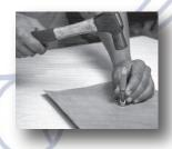
4. Regule o cortador para o corte do diâmetro interno da junta
